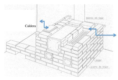
Estos ladrillos se pondrán por unos de sus lados de 0.12 m en medio del horno y la parrilla la separación será solo
